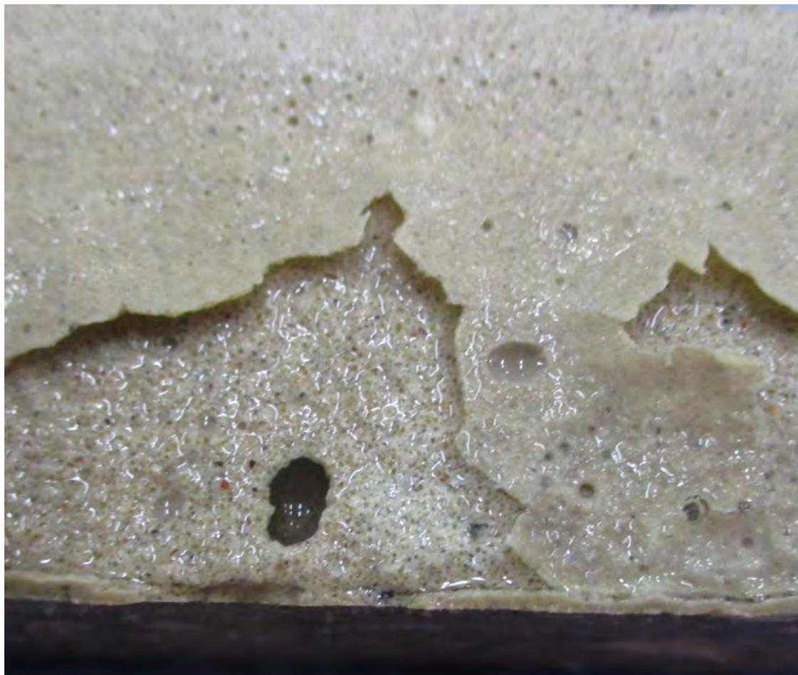
Разрушения в тонкошовном растворе, вызванные сульфатной коррозией
