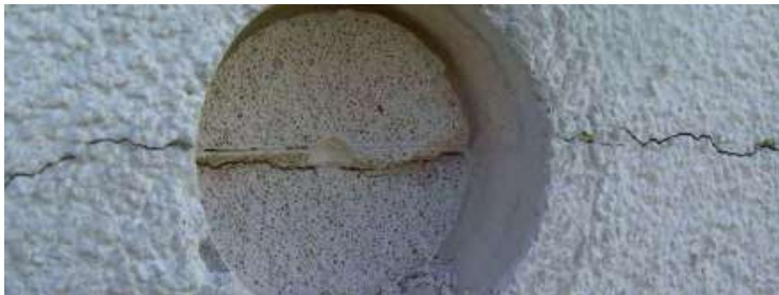
Высверленные образцы с мест образования трещин
