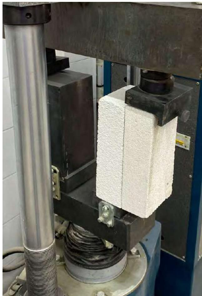
Определение предела прочности при сдвиге
