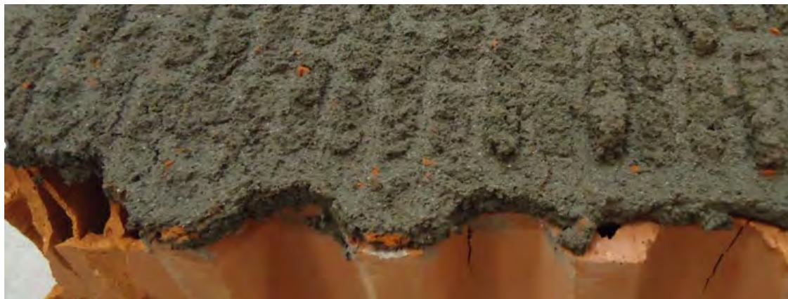
Раствор, нанесенный на поверхность блока
