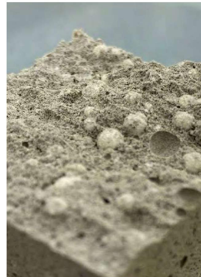
Разлом затвердевшего раствора LM 21-P
