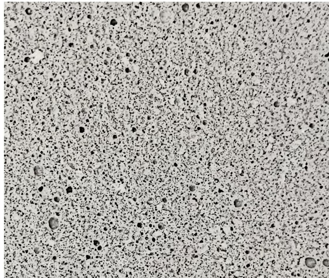
Равномерно распределенные воздушные микропоры в затвердевшем растворе LM
