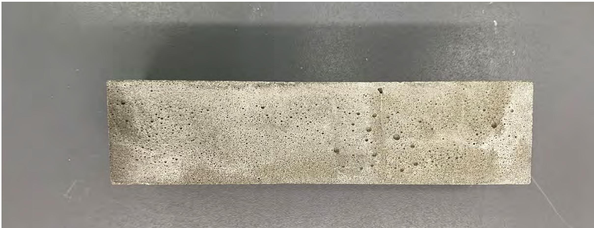
Тонкошовная кладочная смесь quick-mix GBK - после проведения испытаний на сульфатостойкость разрушений нет
