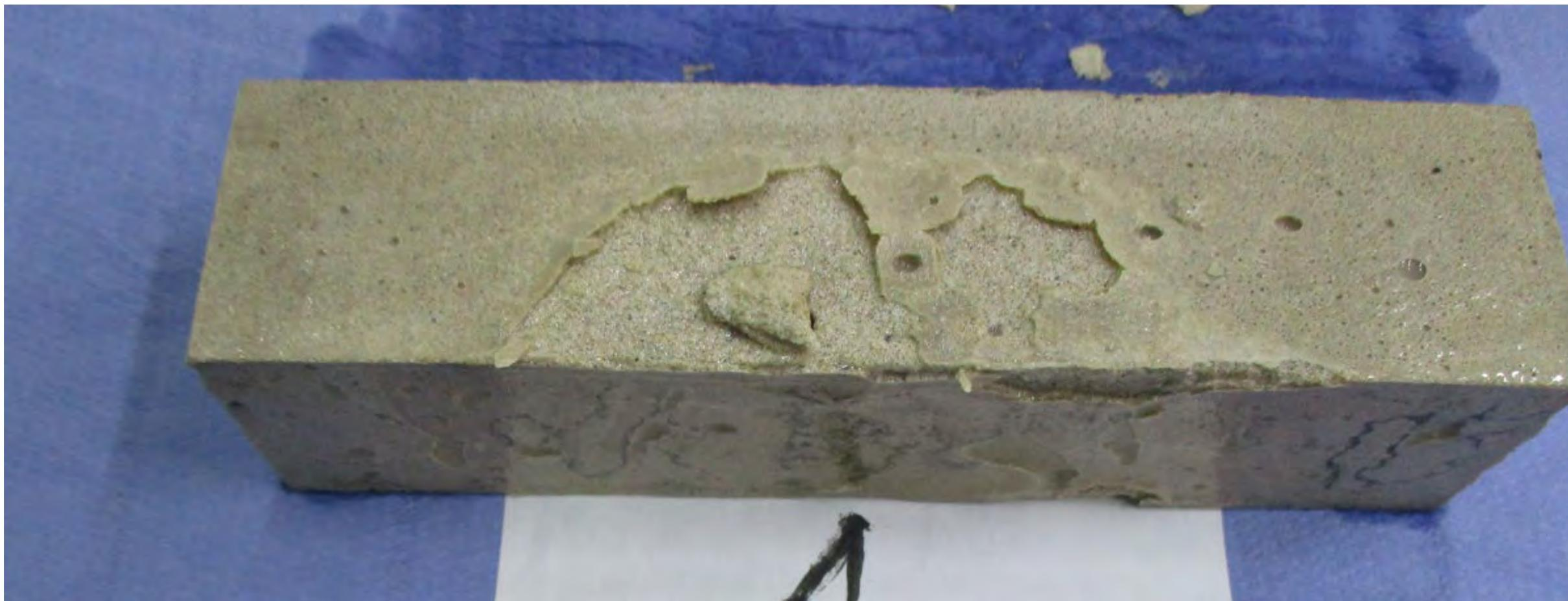
Смесь конкурентов - разрушение тонкошовного раствора после проведения испытаний на сульфатостойкость
