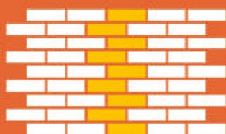
Ложковая кладка смещение на 1/2 кирпича
