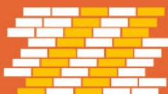
Ложковая кладка косое смещение на 1/4 кирпича
