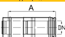
Элемент трубы раздвижной 375 - 585 мм + хомут
