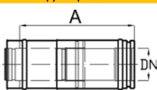
Элемент трубы раздвижной 375 - 585 мм + хомут
