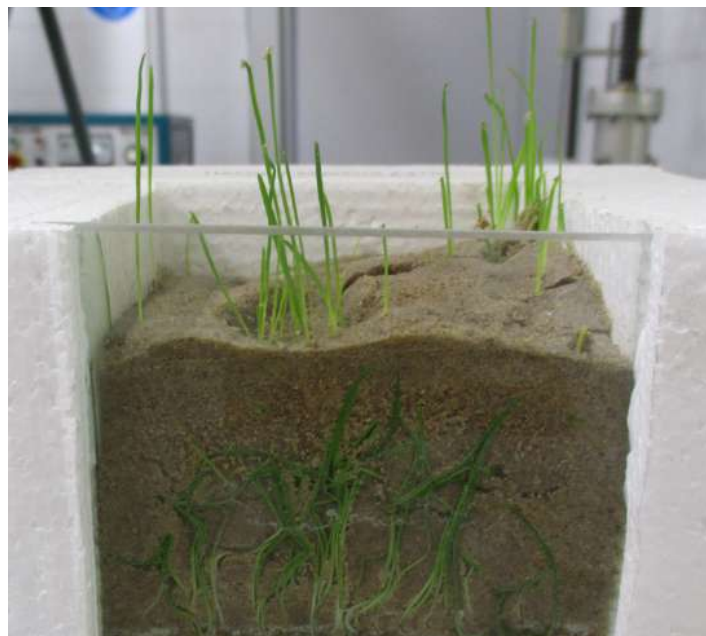
Прорастание сорняков через модифицированный песок FUS
